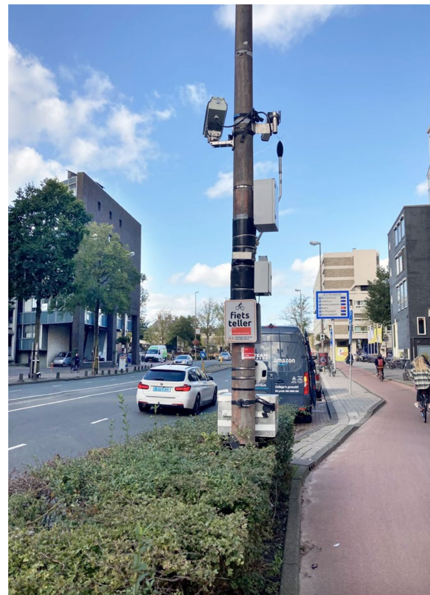
Figuur 1 (boven). Meetopstelling geluidmetingen in Amsterdam. Bron: TNO [3]
